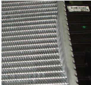
Fig. 3-12 Verformungen an Boden und Seitenteilen
