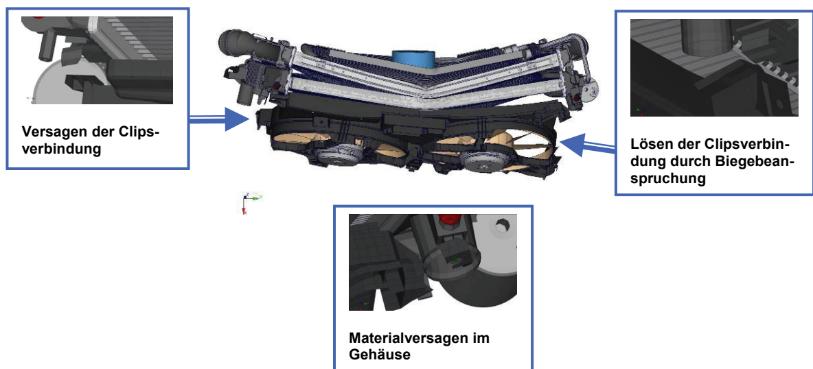
Fig. 4-26 Biegeversuch am Gesamtmodul
