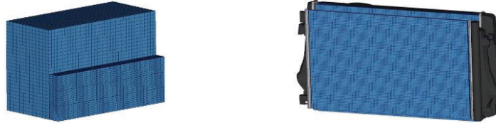
Fig. 4-1 FE-Modell ODB-Barriere (li.) und Kühlmodul (re.)
