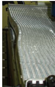
Fig. 3-12 Verformungen an Boden und Seitenteilen
