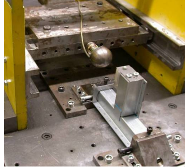
Bild 21: Aufbau des quasistatischen Versuchs mit Hydraulikeinheit (linkes Bild) und des dynamischen Versuchs am T-Stoss mittels eines Impaktors (rechtes Bild) [1]
