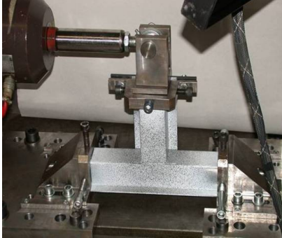
Bild 21: Aufbau des quasistatischen Versuchs mit Hydraulikeinheit (linkes Bild) und des dynamischen Versuchs am T-Stoss mittels eines Impaktors (rechtes Bild) [1]
