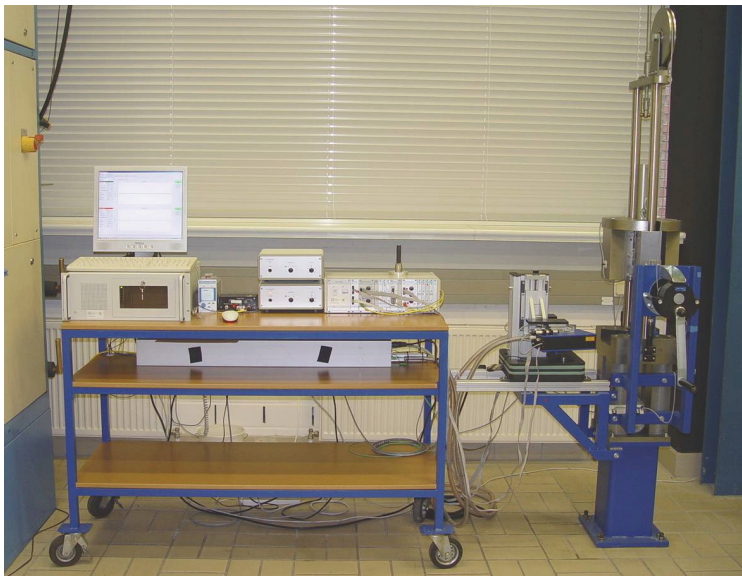
Bild 9: a) Versuchsaufbau für Schlagbeanspruchung
