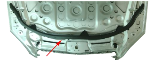
Kollabierende Abstützung Schallisolierung
