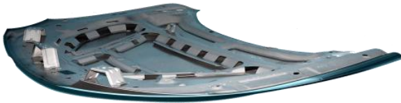
OEM 3: „deformierbare Konsolen“
